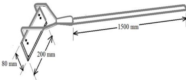
Figure (d) Straight blade hand hoe
