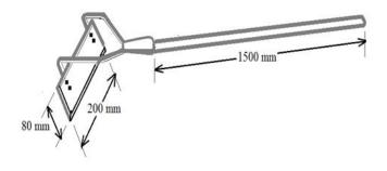
Figure (d) Straight blade hand hoe
